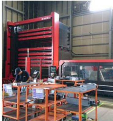
レーザー加工機(材料供給装置10段)
