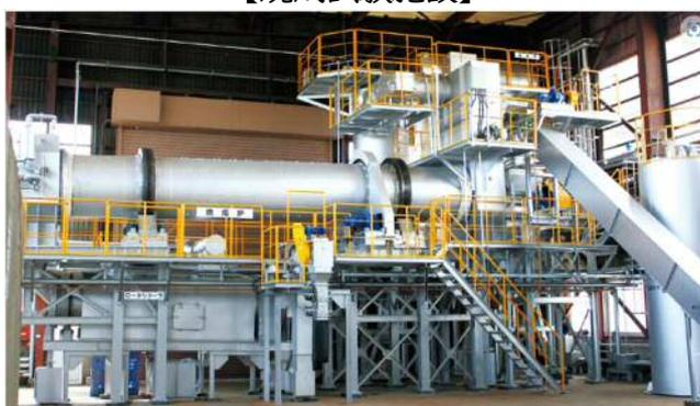
ロータリーキルン式焼成炉 焼却炉で発生した焼却灰を1050℃の高温で焼結する焼成炉です。
